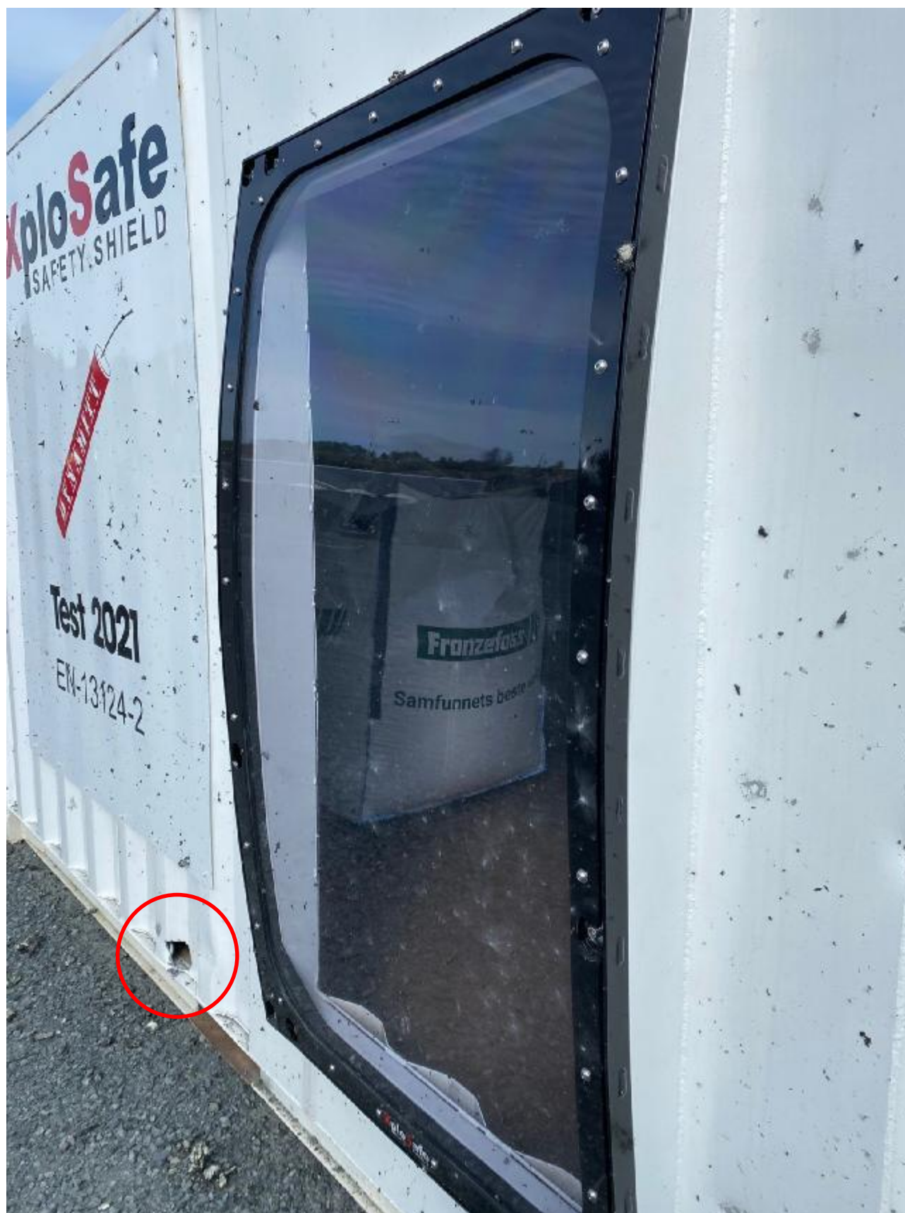
Bilde 4. Etter sprengning. Ramme fikk kun noen skjønnhetsfeil. Vindu fikk små skader, men ingen hull. Legg merke til at kontaineren fikk hullskader.
