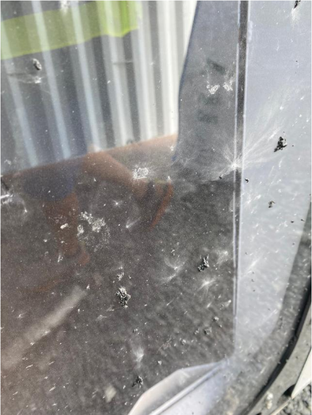
Bilde 7. Utover skaden som vist i bilde 6 ble det mindre overflateskader uten sprekkdannelser.
